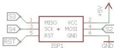
23.ábra ISP programozó csatlakozó megjelenése a kapcsolásban
